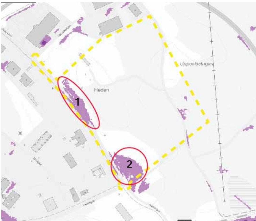
Utklipp från Länsstyrelsens lågpunktskartering (Södermanlandskartan – publika webbkartan, Länsstyrelsen, 2020). I de inringade områdena varierar djupet på lågpunkterna mellan 0,1-1m.
